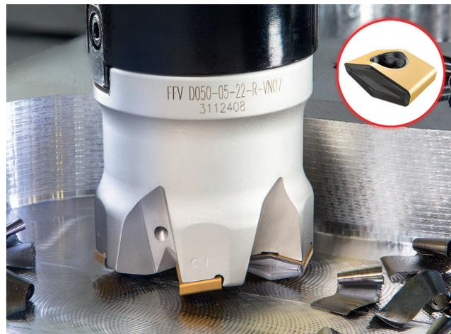
**Variabel:** Der Tang4Feed-Hochvorschub-Aufsteckfräser mit tangential geklemmten, rhombischen Wendeschneidplatten lässt sich mit verschiedenen Schneidengeometrien bestücken
